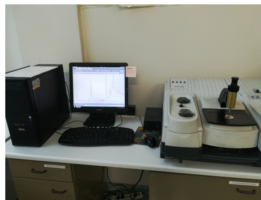
Stanowisko do analizy grup funkcyjnych Spektrometr w podczerwieni FTIR
