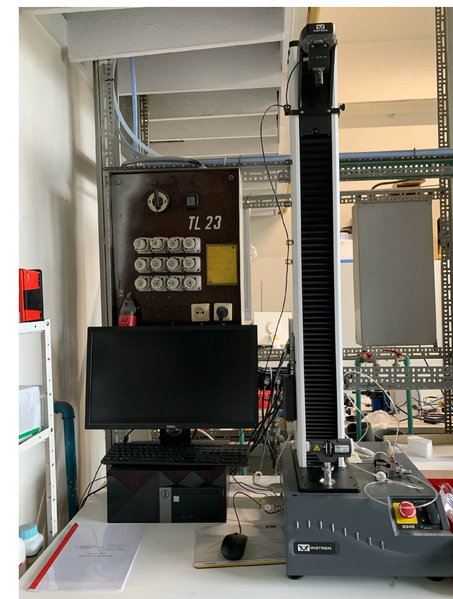
Stanowisko do analizy właściwości wytrzymałości biomateriałów
