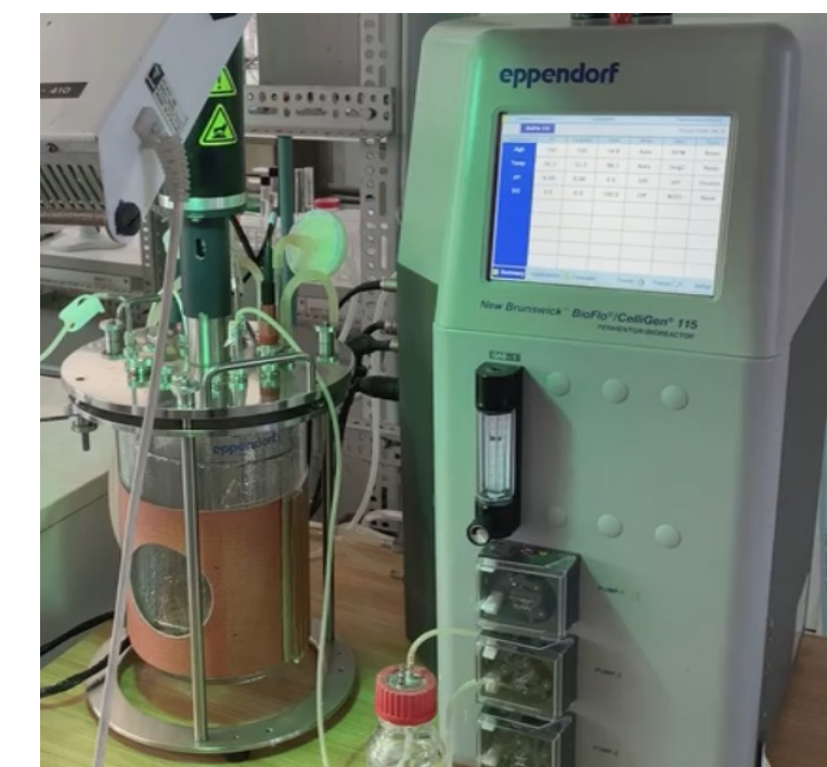
Lewa: Bioreaktor automatyczny o działaniu półokresowym do hodowli mikroorganizmów
